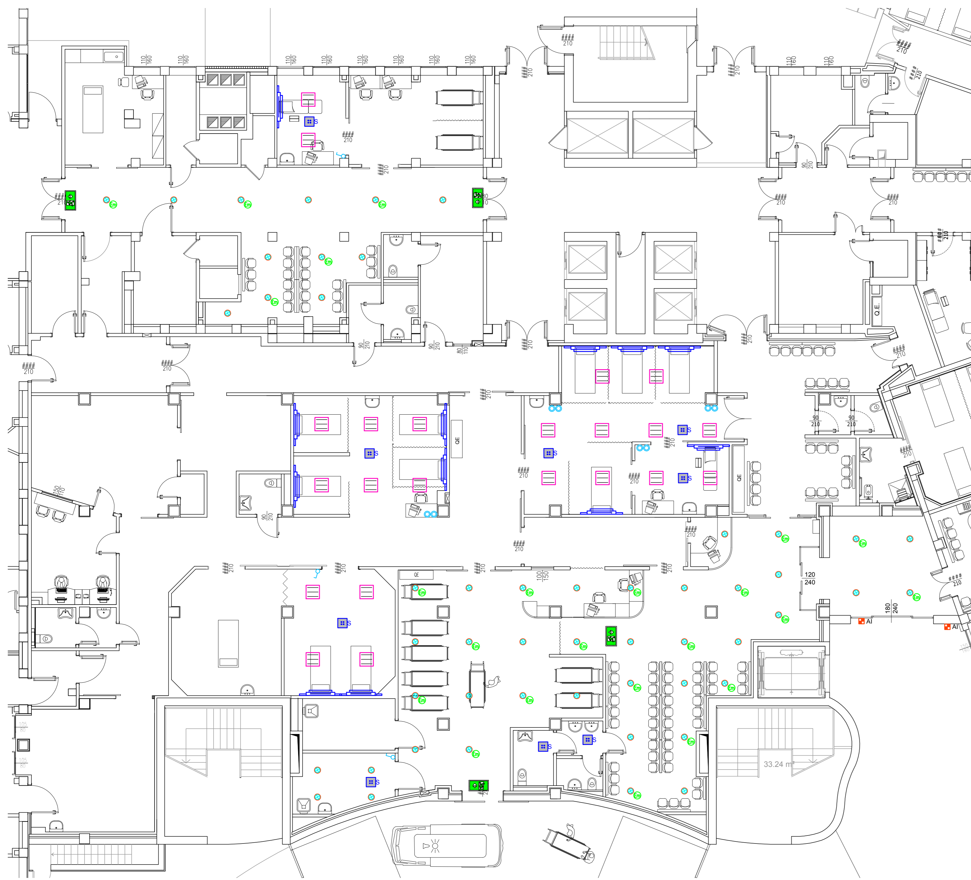
Distribuzione quadri e canalizzazioni principali
