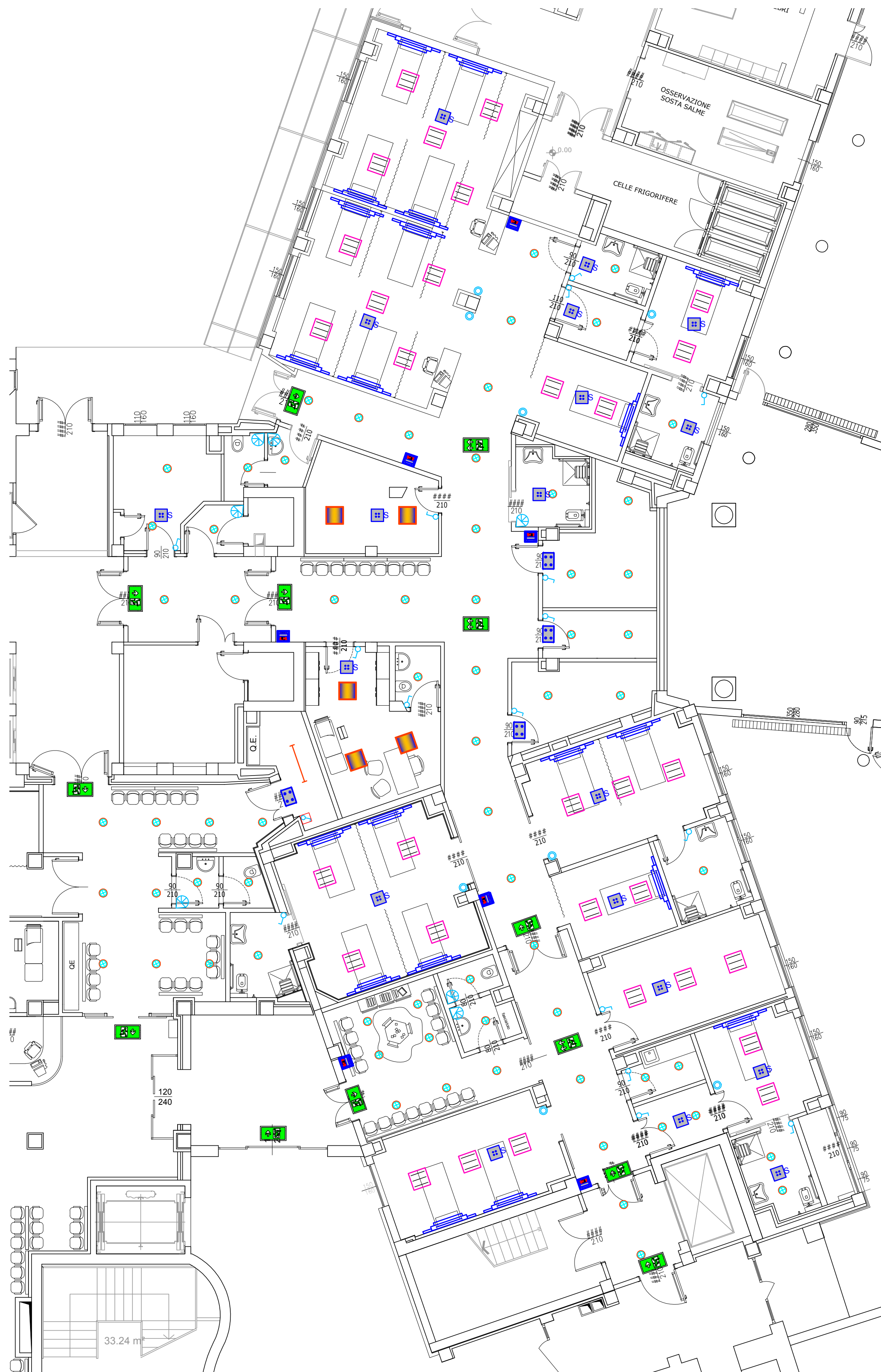
Distribuzione quadri e canalizzazioni principali
